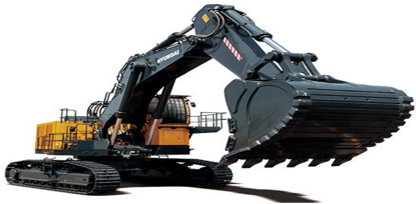
그림 17. 국내에서 HD현대건설기계가 유일하게 생산하는 120t급 굴삭기, R1250
